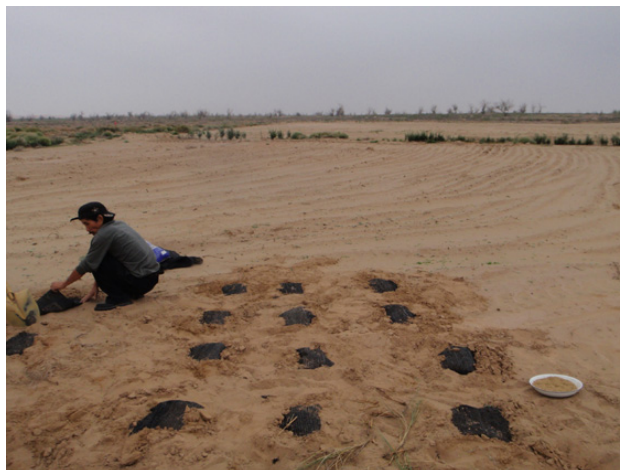
(種子を入れた袋による植生回復を図るバッグ工法試験)
