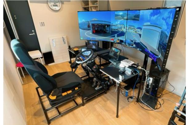
《遠隔センター(遠隔運転操縦装置)》
