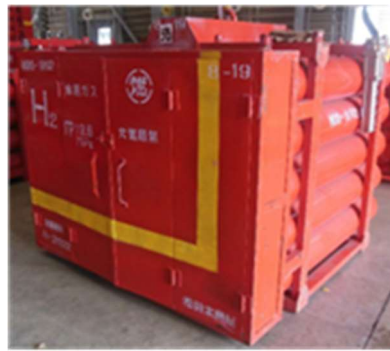
カードル(水素充填容器)
