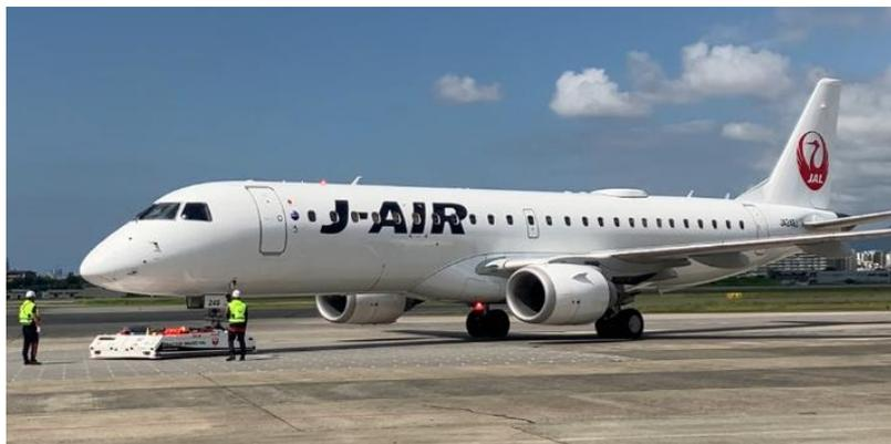
リモコン式航空機牽引車は、従来の牽引車と異なり運転席を持たず、作業者が車両から離れた位置でリモコン操作により航空機のプッシュバック作業を行うことが可能です。
