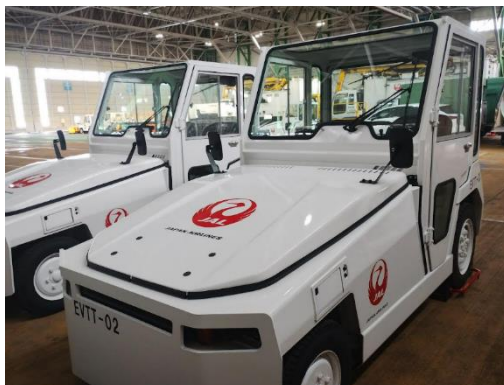
EVトーイングトラクターのルーフは北海道の冬を想定した仕様となっている
