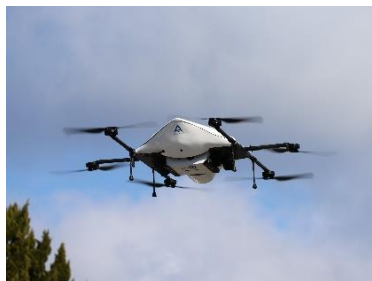
実証実験に使用された 日本初の物流専用ドローン “AirTruck”（技術検証試験機）
