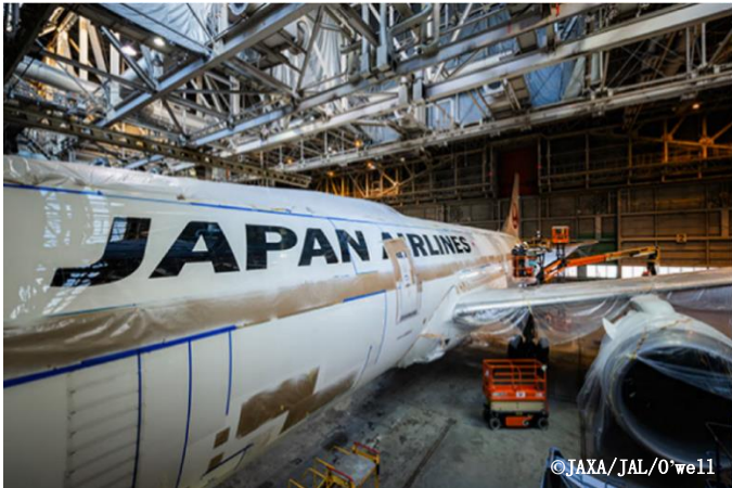
リブレット施工作業風景
