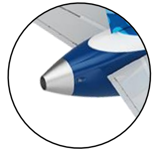
胴体後方の空力性能向上 (削減効果:1%)
