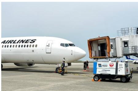
松山空港に導入したeGPU(*) (*)リチウムイオンバッテリー式電源装置
