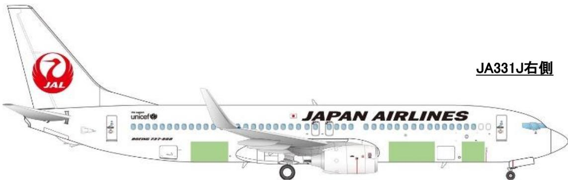
今後、大面積施工したリブレット形状の耐久性、美観性、および燃費改善効果を確認していきます。また、来年度以降、より効果の高い国際線機材へのリブレット形状の施工を展開することで、さらなるCO<sub>2</sub>排出量の削減に取り組んでまいります。
